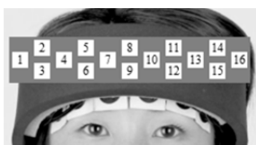
図 1 装置装着例と ch 位置
